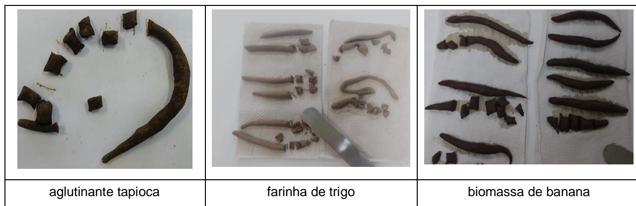
Figura 5– Moldes de diversas formulações e aglutinantes.
