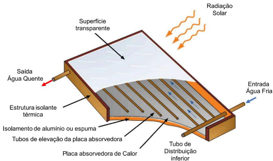
Figura 2 – Diagrama esquemático de coletor solar do tipo placa plana
