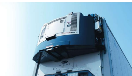
Figura 7 – Genset com clipe preso a lateral do container
