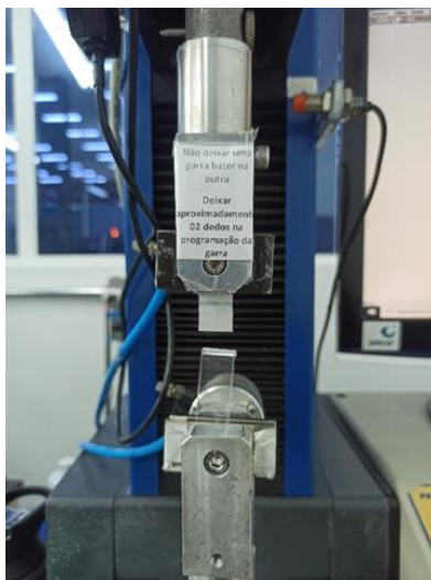
Figura 1 – Ensaio de tração
