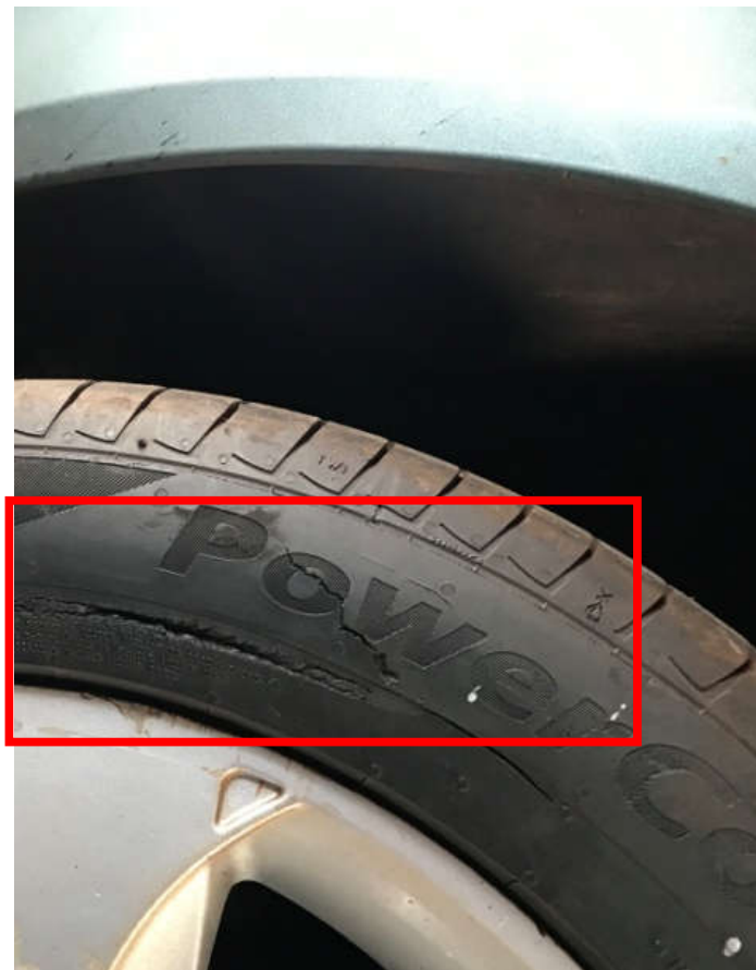
Figura 12 – Pneu com rachadura
