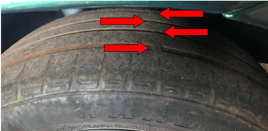
Figura 5 –Veículo leve com pneu irregular
