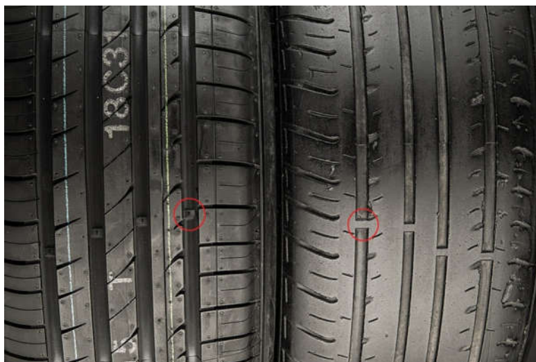
Figura 1 – Exemplo de pneus e o Indicador de Desgaste da Banda de Rodagem ( TWI )
