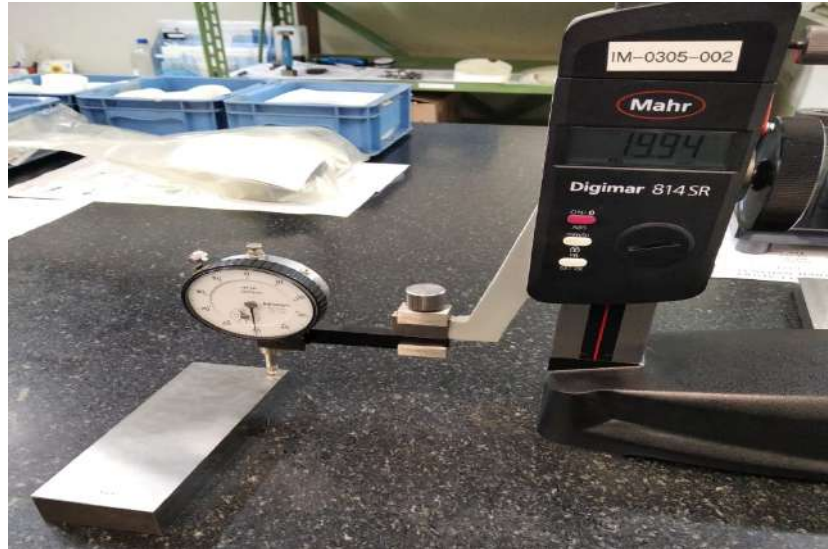
Figura 5 - Procedimento de medição de altura das amostras
