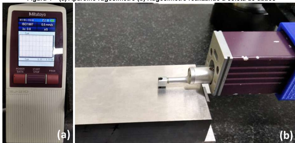
Figura 4 – (a) Aparelho rugosímetro (b) Rugosímetro realizando a coleta de dados
