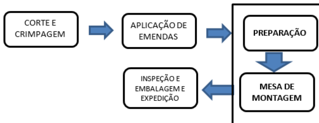
Figura 2 – Fluxograma do processo de montagem de chicote elétricos
