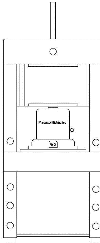
Figura 1. Projeto no AutoCAD da prensa hidráulica com chapa aquecedora.
