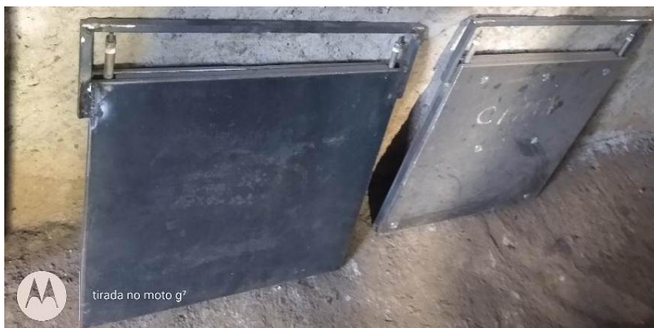
Figura 3. Chapas aquecedoras montadas (Parte inferior e superior).
