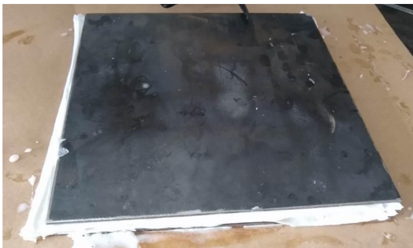
Figura 10. Placa de Celeron antes de ser prensada.
