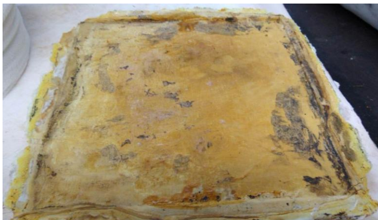
Figura 11. Placa de Celeron após ser prensada.
