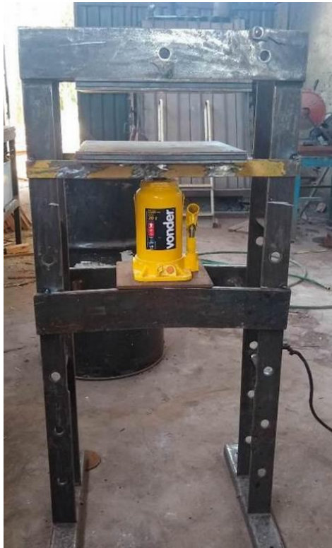
Figura 5. Prensa hidráulica com as chapas aquecedoras soldadas.
