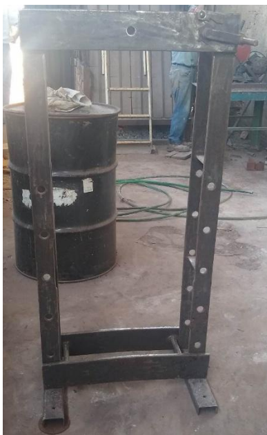
Figura 4. Estrutura utilizada para a construção da prensa.
