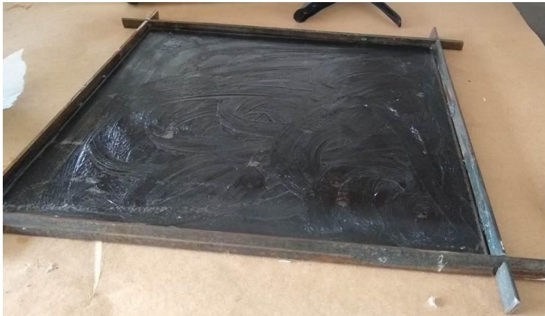
Figura 9. Molde para fabricação da placa de Celeron.
