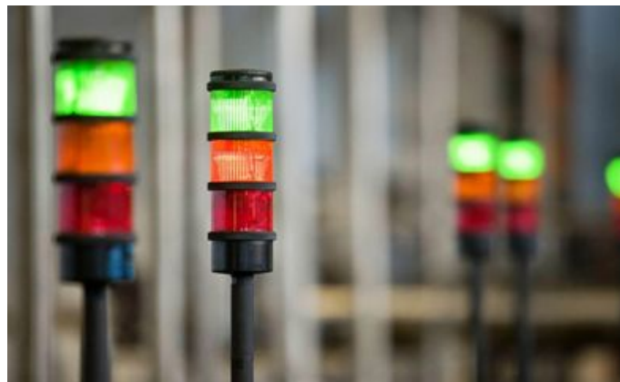
Figura 2 – Exemplo de sinalizadores Andon.
