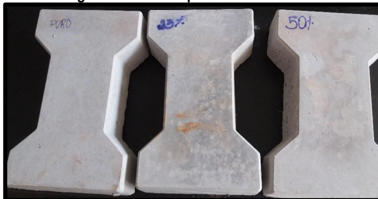
Figura 2 – Pavers após a cura de 28 dias
