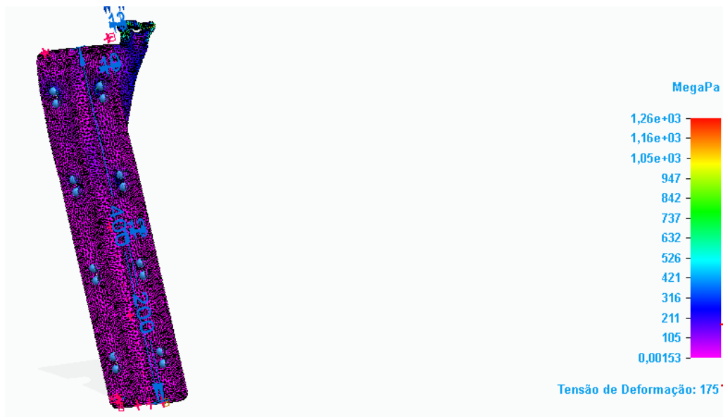
Figura 6 – Resultados numéricos do desenvolvimento computacional de uma chapa de fixação
