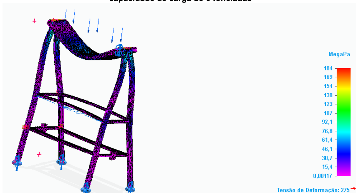
Figura 7 – Resultados numéricos do desenvolvimento computacional de um cavalete com capacidade de carga de 6 toneladas
