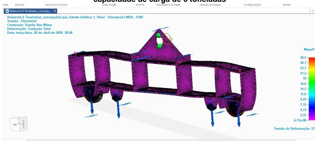
Figura 2 – Resultados numéricos do desenvolvimento computacional de um balancim com capacidade de carga de 6 toneladas
