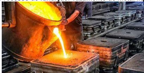
Figura 1. Processo de fundição. Vazamento de metal líquido em molde
