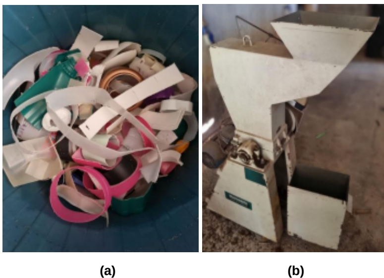
Figura 4. (a) Fragmentos de PEAD após corte primário (b) Picador Marconi
