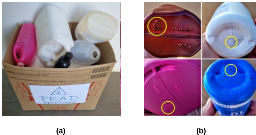
Figura 1. Polietileno de alta densidade a) Coleta de plásticos; b) Identificação do plástico.
