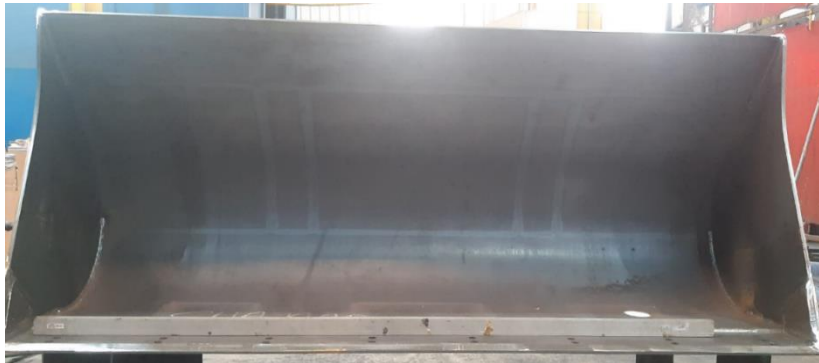
Figura 8 – Régua de alumínio para conferir o alinhamento
