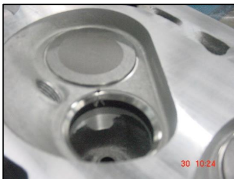
Figura 2 – Foto de um cabeçote 2.0 L: detalhe do conjunto válvula e sede de válvulas
