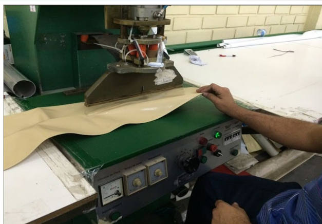
Figura 3 – Processo de solda das lonas
