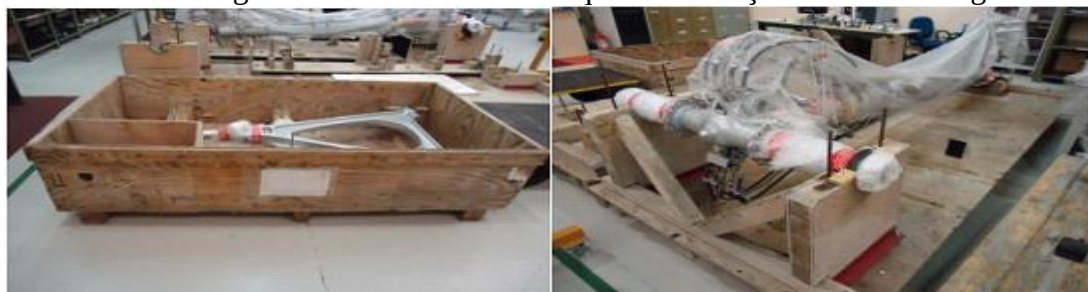
FIGURA 15: Embalagem para transporte de trem de pous
