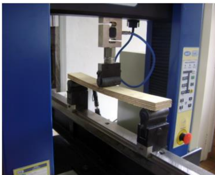
Figura 3-Teste de flexão estática em amostra de compensado
