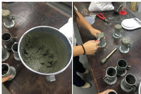
Figura 1 – Moldagem dos corpos de prova de argamassa
