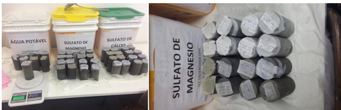
Figura 2 – Verificação do ataque de sulfatos em corpos de prova de argamassa
