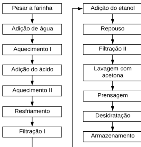
Figura 4 – Diagrama de extração ácida e precipitação alcoólica de pectina
