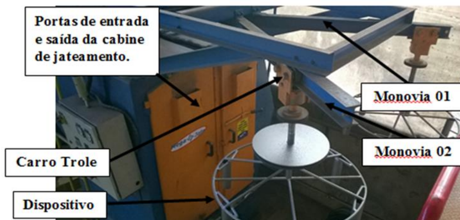
Figura 2 - Vista superior da cabine de jateamento e monovias de abastecimento
