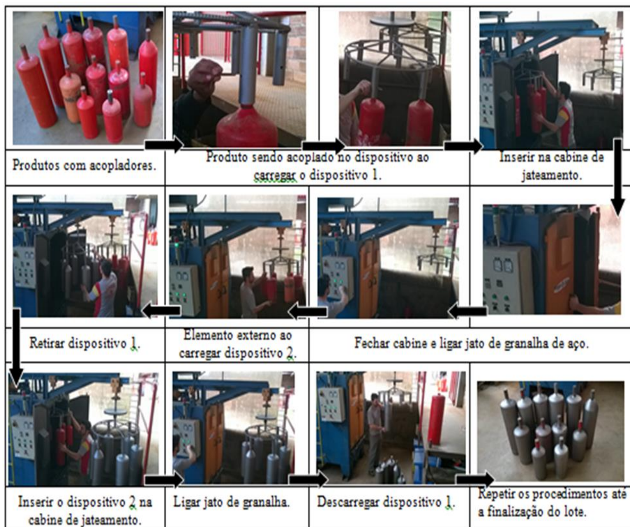
Figura 5 - Fluxogramas do método melhorado após a reformulação do dispositivo
