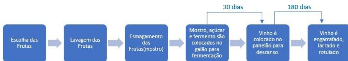
Figura 2: Fluxograma da produção do vinho de uva feito com uva in natura
