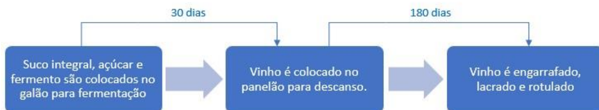
Figura 3: Fluxograma da produção do vinho de uva com suco integral
