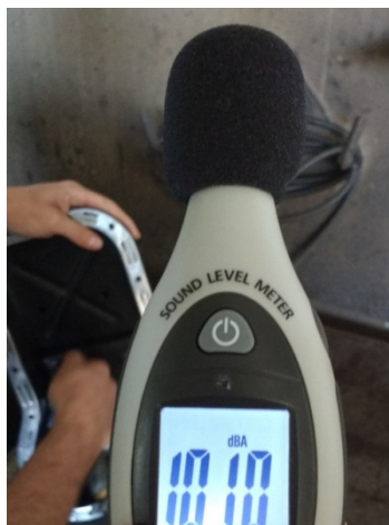
Figura 3 – Medição de ruído na limpeza utilizando jato de ar
