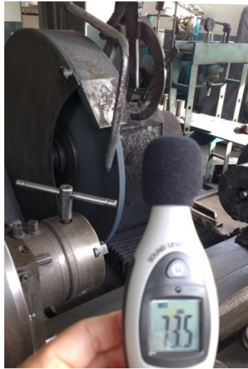
Figura 2 – Medição do ruído da máquina retificadora de virabrequim
