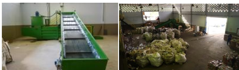
Figura 4 – Prensa para compactar resíduos recicláveis, à esquerda (1); Resíduos recicláveis separados por tipos nos bags, à direita (2)
