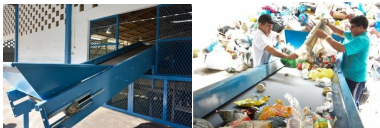
Figura3 – Esteira para a triagem de resíduos recicláveis, à esquerda (1); Processo de triagem, à direita (2) Fonte: https://www.blumenau.sc.gov.br/secretarias/samae/samae/servicos-de-reciclagem53
