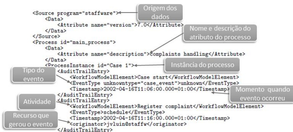
Figura 2 - Fragmento de um arquivo no padrão MXML
