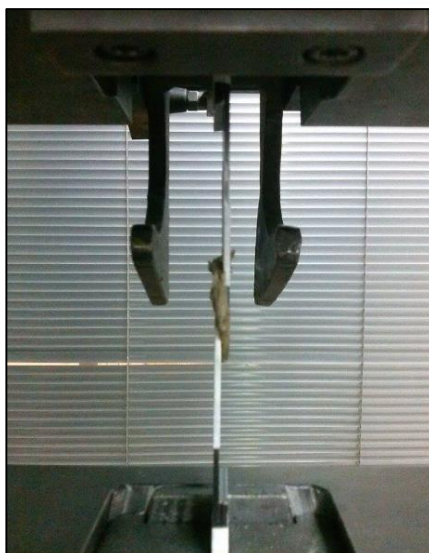
Figura 7 – Corpo de prova fixado na máquina para realização do ensaio de cisalhamento.
