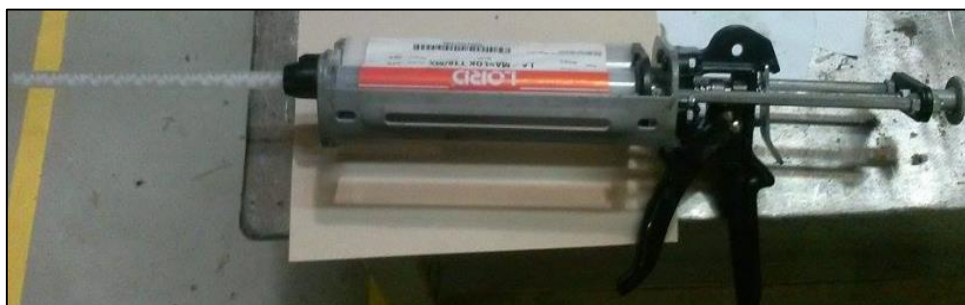
Figura 6 - Pistola para aplicação manual do adesivo.
