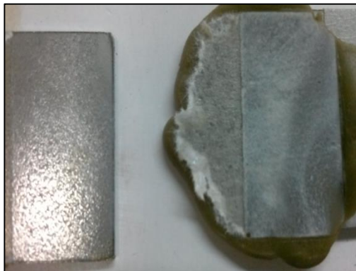
Figura 8 – Ruptura adesiva na junta sem preparação superficial.
