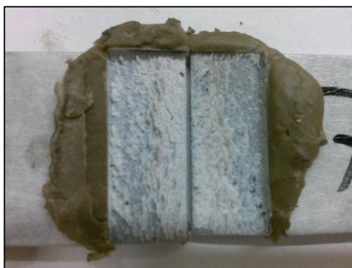
Figura 9 - Ruptura coesiva na junta preparada com álcool e lixamento.
