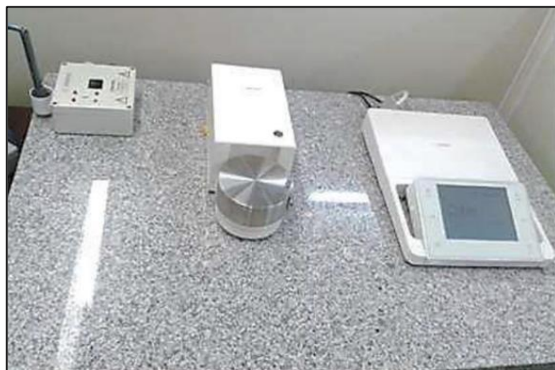
Figura 5 – Microbalança e caneta eliminadora de eletrostática
