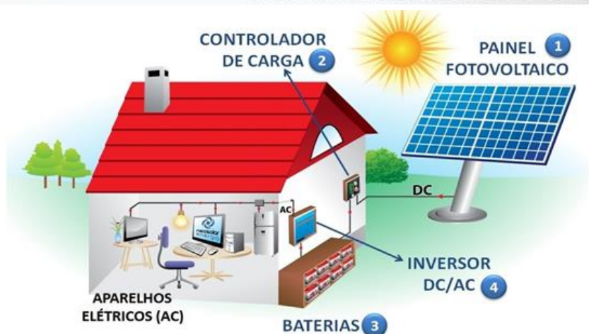
Figura 6 – Sistema de Energia fotovoltaica
