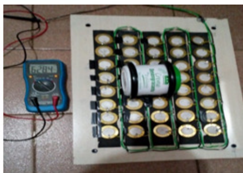
Figura 9 e 10: Materiais utilizados para aumentar a área de contato do objeto cilíndrico, com os piezos Fonte: próprio autor (2018)
