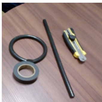
Figura 9 e 10: Materiais utilizados para aumentar a área de contato do objeto cilíndrico, com os piezos Fonte: próprio autor (2018)
