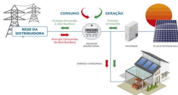
Figura 2 – Representação de um sistema On-grid.
