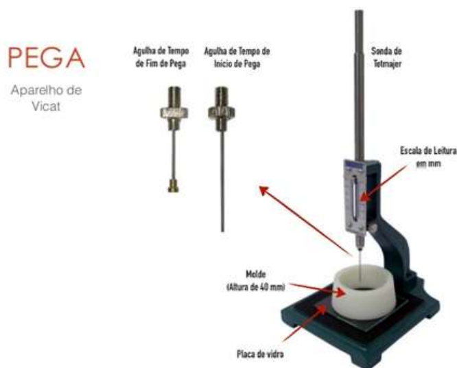
Figura 1 – Aparelho de Vicat – Determinação do início e fim de pega.
