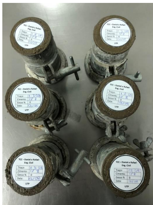
Figura 5 – Moldagem dos corpos de prova – Fonte: Autores, 2018
