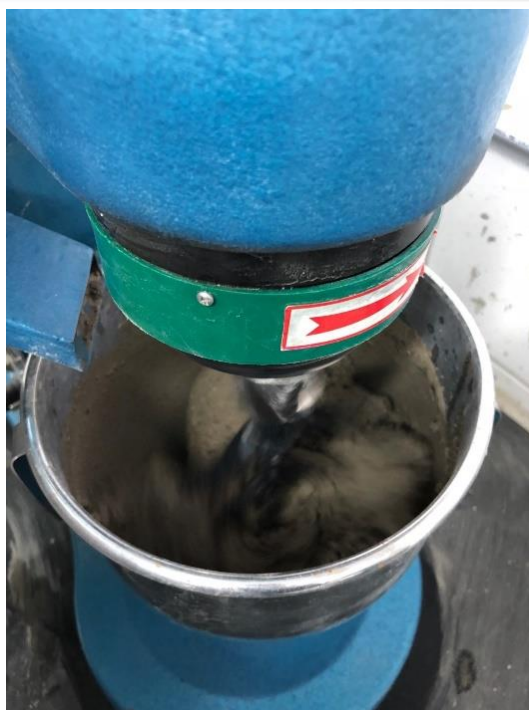
Figura 4 – Argamassadeira automática utilizada para a produção da argamassa – Fonte: Autores, 2018
