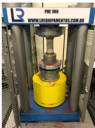
Figura 7 – Corpo de prova sendo submetido ao ensaio de compressão simples – Fonte: Autores, 2018
