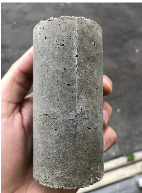
Figura 8 – Corpo de prova CP 29 com fissuras - Fonte: Autores, 2018
