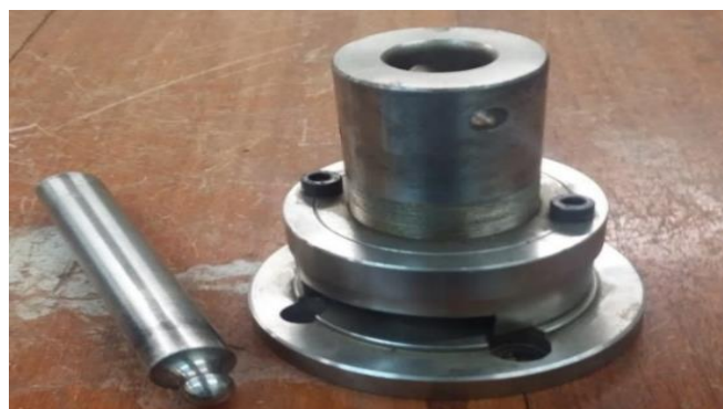
Figura 2 – Equipamento adaptado para ensaio de embutimento
