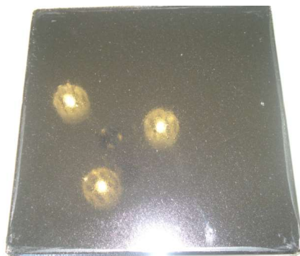
Figura 3: Placa de resina termofixa com adição de 60% de resíduo de pneu
