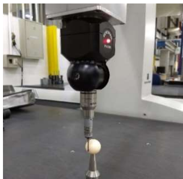
Figura 2 - Medição da esfera padrão por apalpação (HEXAGON MANUFACTURING INTELLIGENCE, 2018).
