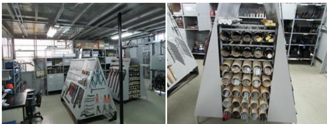
Figura 6 – Ferramentaria depois da aplicação do 5S Fonte: Autoria própria.
