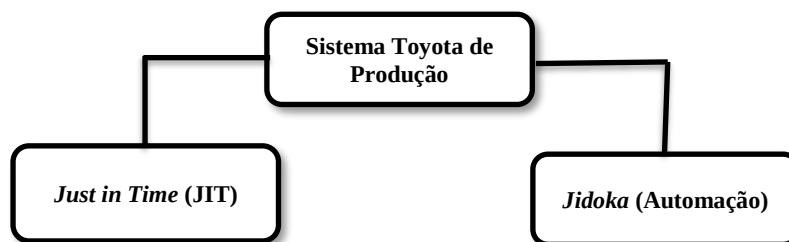
Figura 1 – Pilares do Sistema Toyota de Produção
