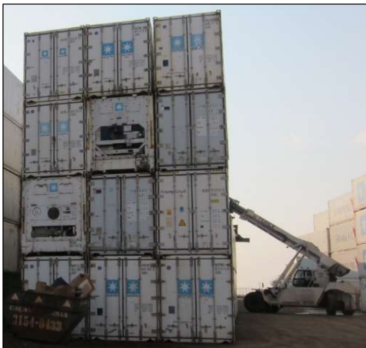
Figura 1 - Pilha de contêineres com três fileiras e quatro níveis
