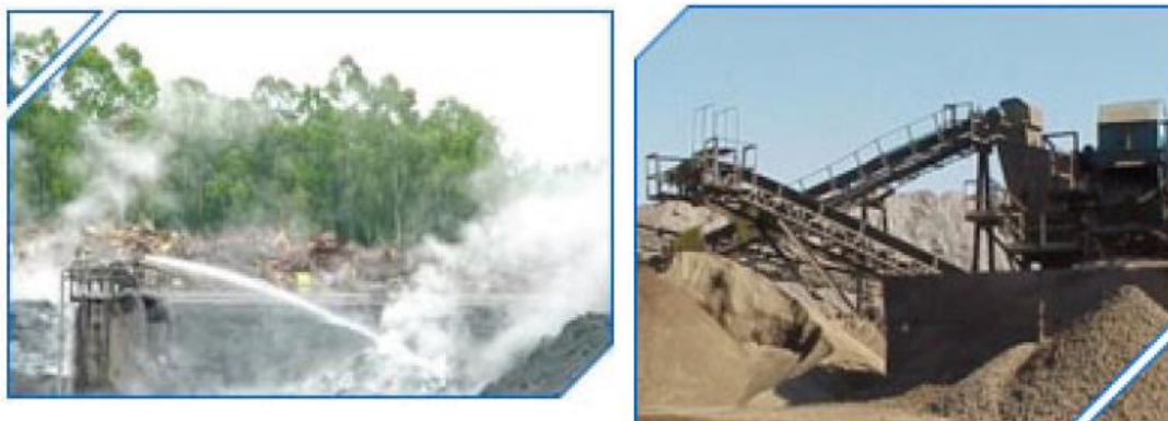
Figura 4 - Resfriamento e Processamento da Escória LD (Relatório de Catálogo de Produtos, 2016)
