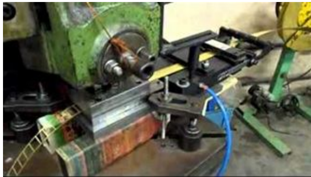
Figura 2 – Prensa excêntrica adaptada com alimentador e desembobinador, possível solução do projeto.
