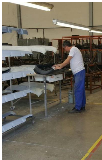
Figura 3 - Processo de aplicação de massa corretiva em uma peça
