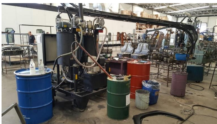
Figura 5 - Área de injeção de poliuretano
