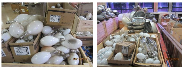
Figura 6 – Lâmpadas mistas/vapor de mercúrio e luminárias ao fim da vida útil [Autor e [4]].
