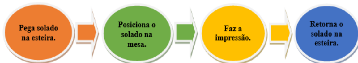
Figura 1 - Fluxograma do processo de serigrafia
