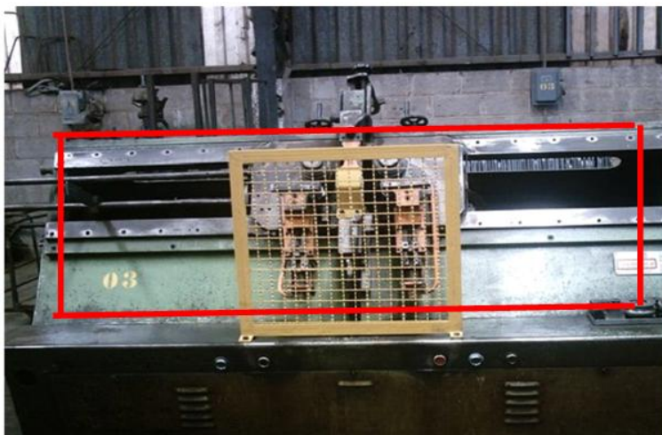
Figura 02 - Imagem frontal demonstrando a falta de proteções
