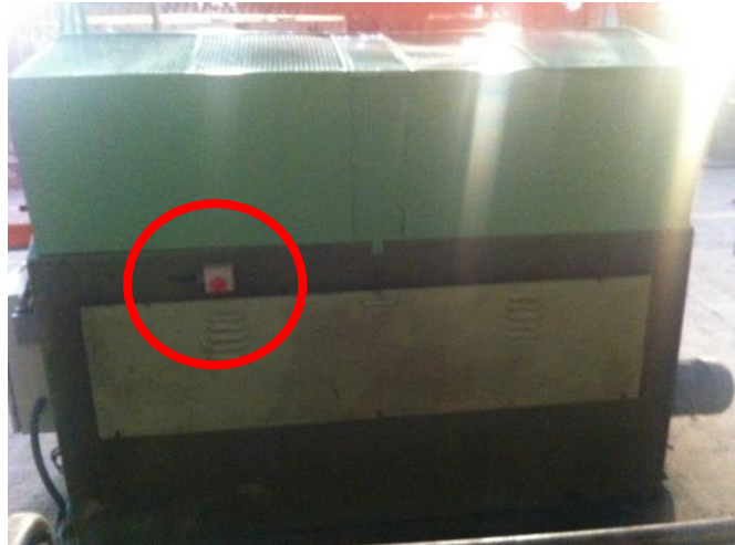
Figura 04 - Detalhe do botão de parada de emergência
