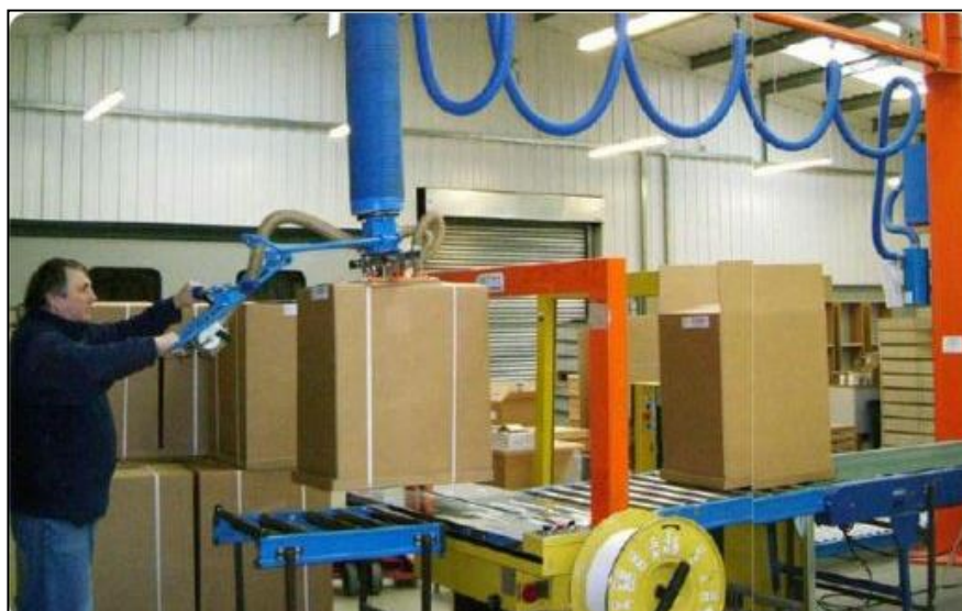
Figura 2- Modelo do manipulador a vácuo para caixas
