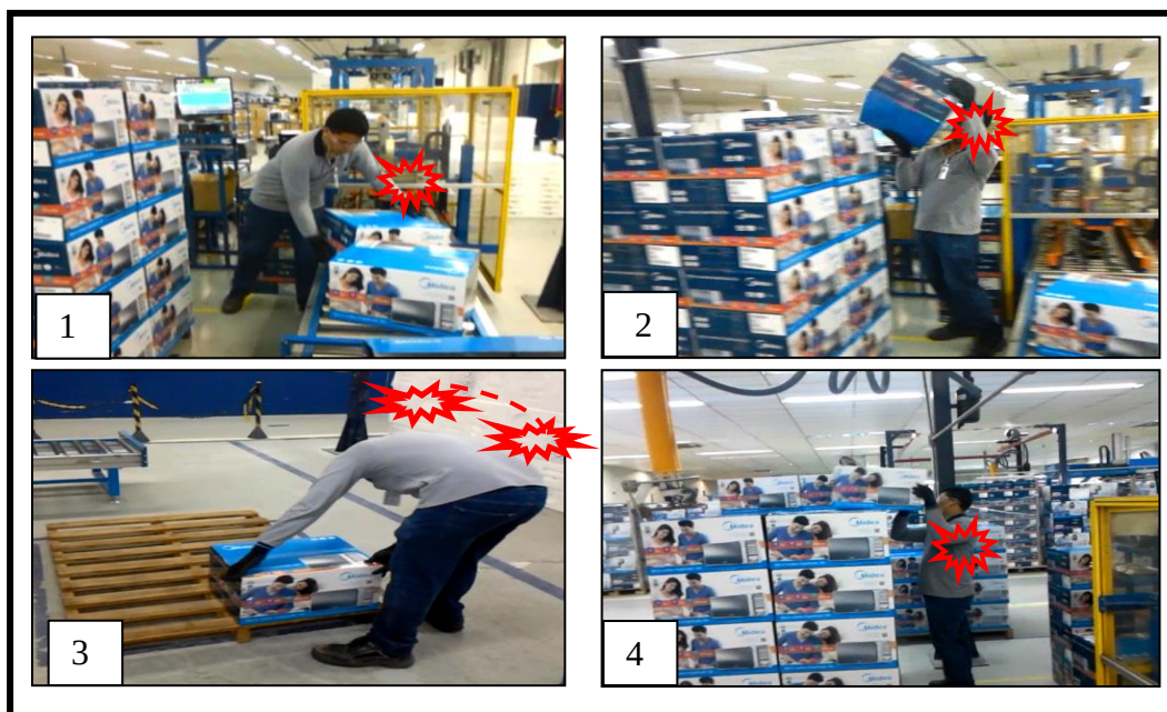
Quadro 1 - Avaliação do posto de trabalho: Levantamento Manual dos fornos Micro-ondas antes das melhorias
