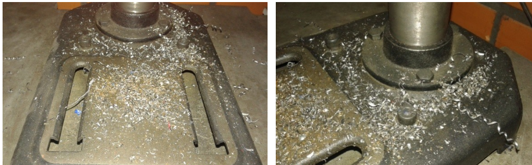
Figura 7 – Cavacos gerados pela furadeira
