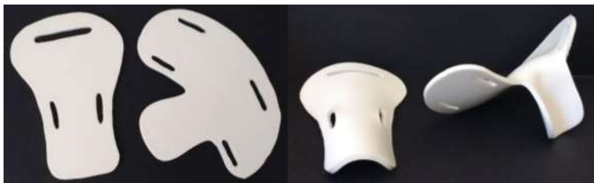
Figura 10 - Peças finais, com espessura 3,0mm, planificadas à esquerda e deformadas à direita
