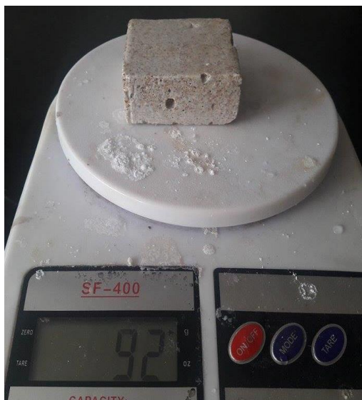
Figura 8 – Pesagem dos blocos, ensaio de absorção
