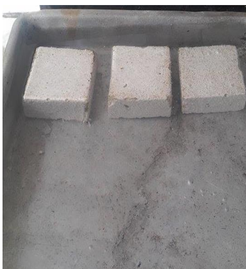
Figura 7 – Ensaio de absorção
