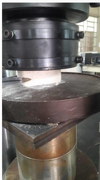
Figura 6 - Carga de ruptura ensaio de resistência
