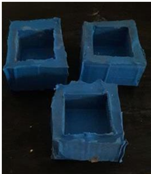
Figura 1 – Formas de borracha de silicone utilizadas para molde das placas
