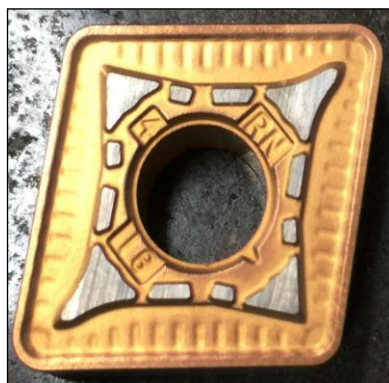
Figura 2 - Inserto CNMG 160616 RN KC9125
