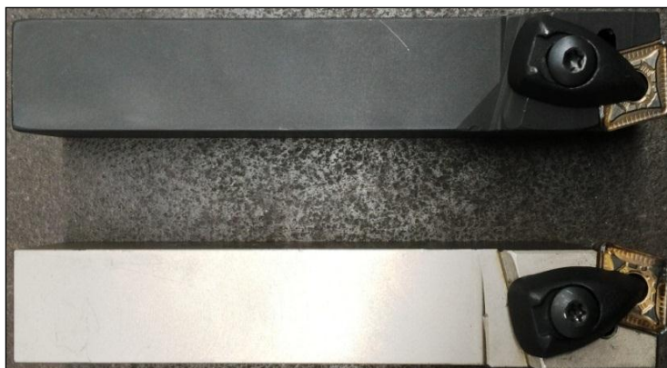
Figura 5 - Suporte especial para torneamento externo utilizando aresta inativa do inserto.
