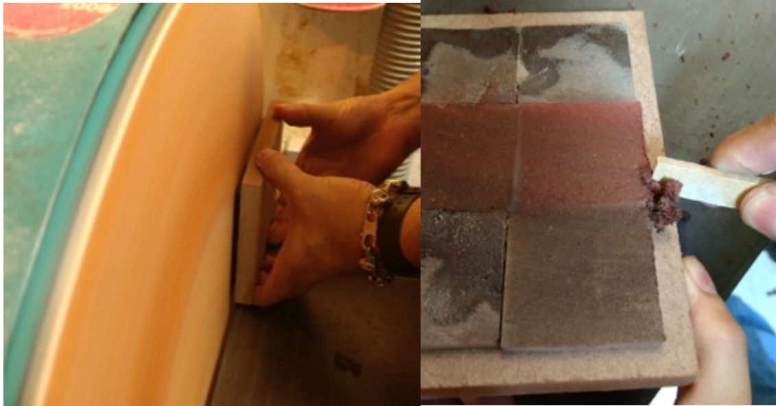
Figura 2 – lixamento da peça e remoção do plástico derretido formado nas bordas
