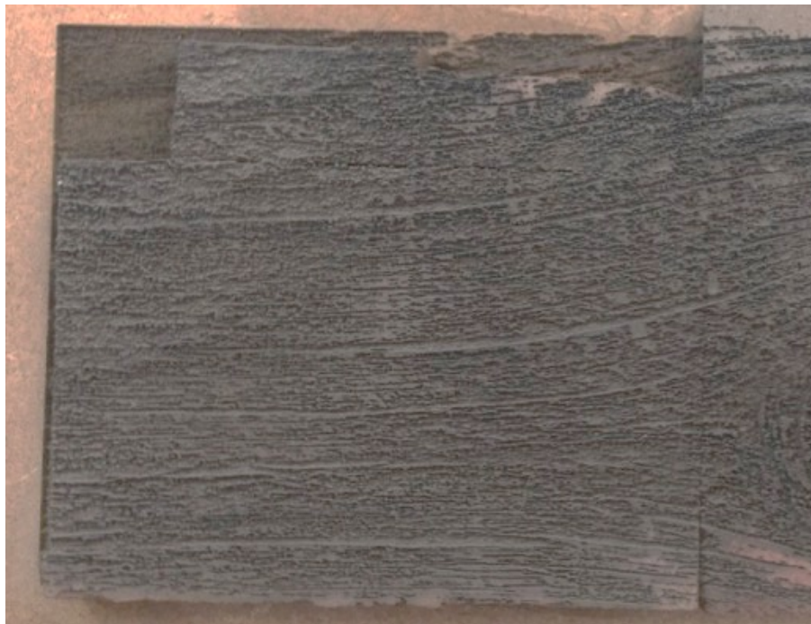
Figura 3 – superfície queimada pela aplicação de feixes de laser em excesso
